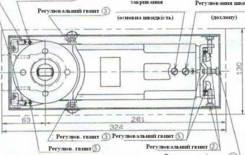
**Регулювання положення дверей і швидкості закривання**
